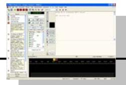
Verifichiamo che l'apparato sia impostato per la banda laterale superiore (USB è lo standard per il psk31) o per la modalità dati se il trasmettitore ne ha una idonea per il psk.
