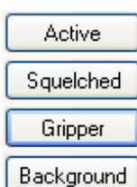
Con i pulsanti presenti nel riquadro Signal / Squelch, possiamo accedere alla finestra di selezione standard di windows per personalizzare i colori della barra segnale/squelch a seconda dello stato in cui si trova.
